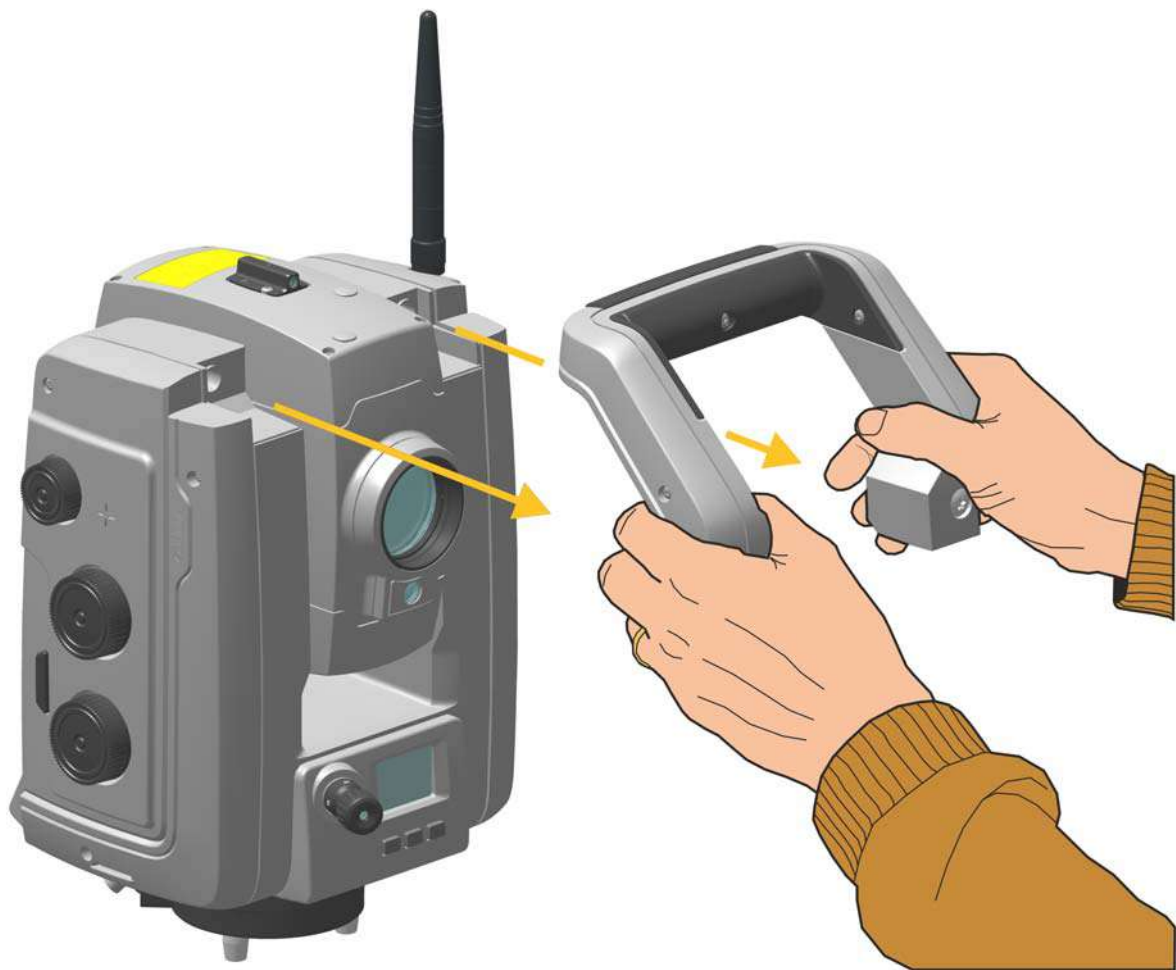
Рисунок 3.14. Отсоединение ручки инструмента
