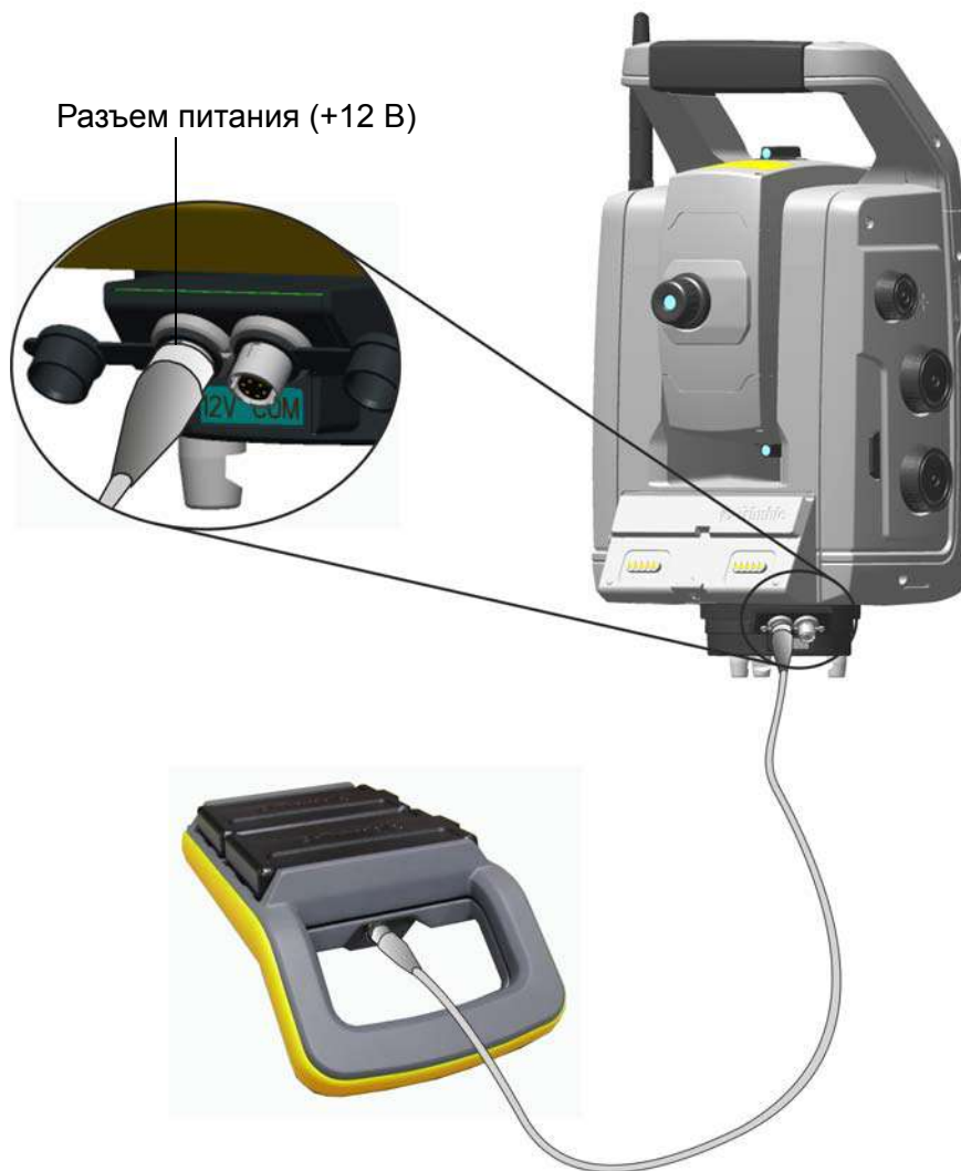
Рисунок 6.2. Подключение адаптера для нескольких батарей
