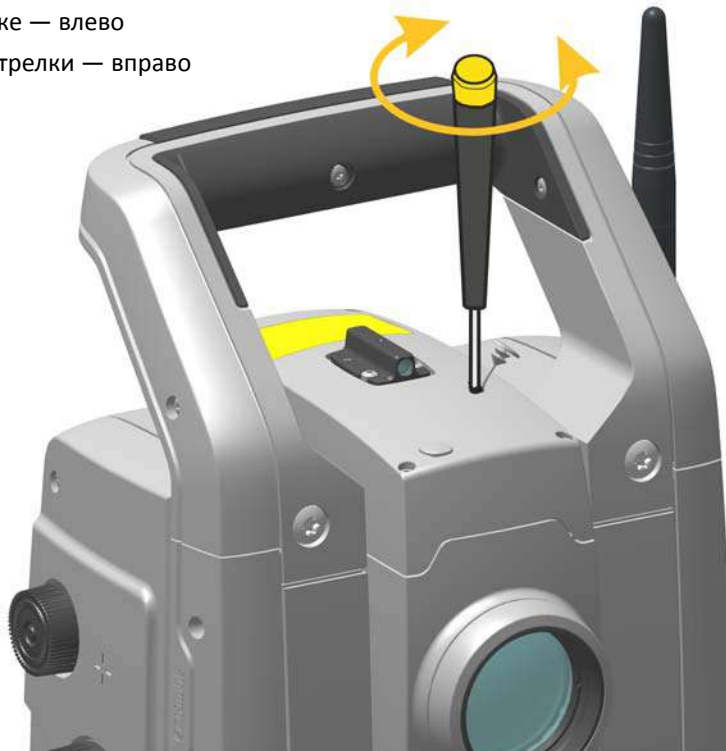
Рисунок 4.7. Юстировка положения лазерного указателя по горизонтали
