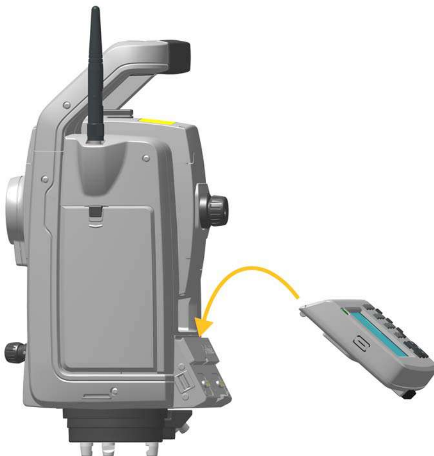
Рисунок 4.12. Установка TCU на инструмент
