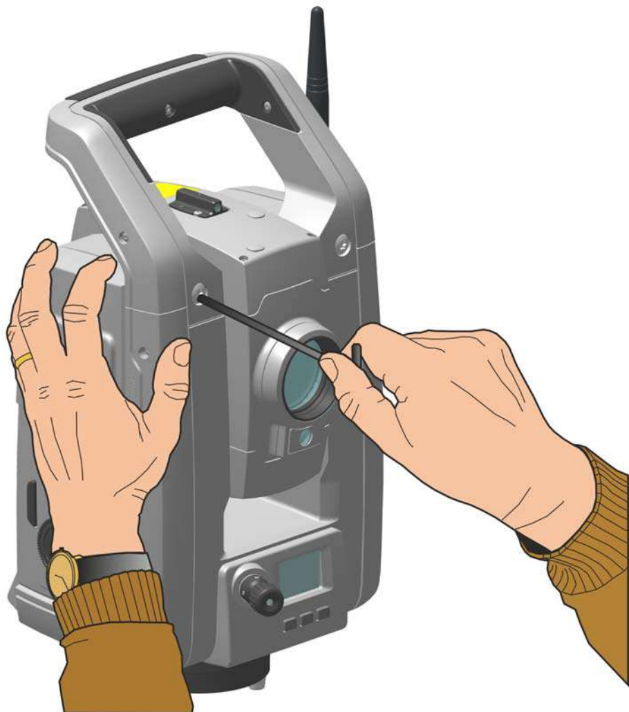
Рисунок 3.13. Отсоединение ручки инструмента
