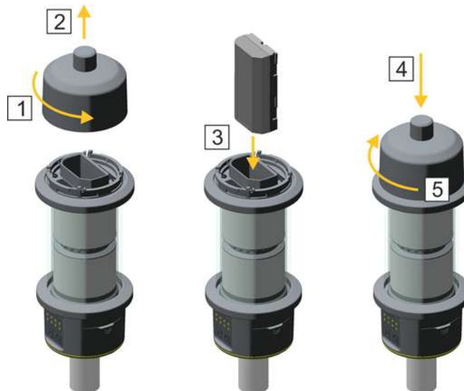
Рисунок 6.15. Установка батареи в цель Trimble Active Track 360
