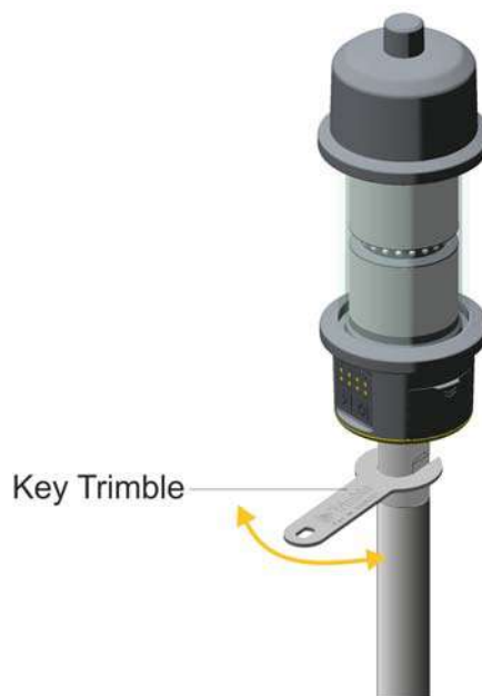
Рисунок 6.17. Установка и снятие цели Trimble Active Track 360
