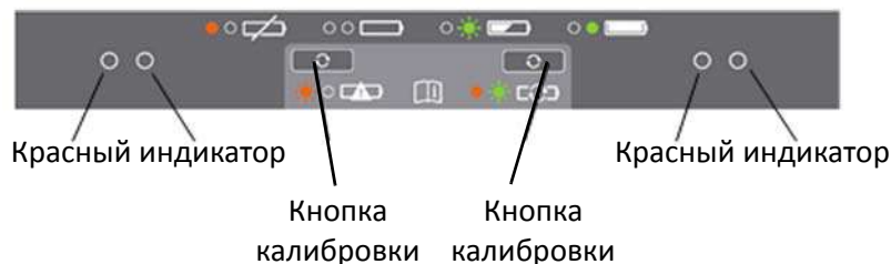
Рисунок 3.6. Панель управления зарядного устройства на две батареи
