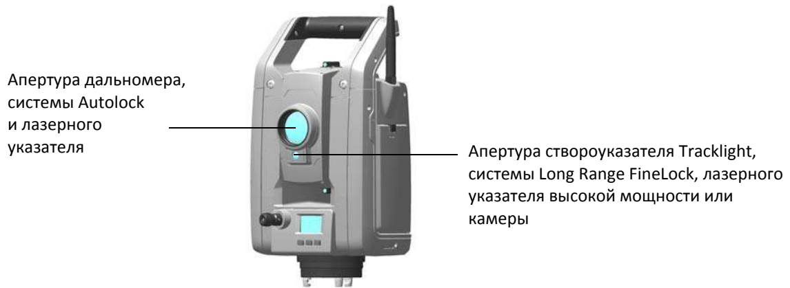
Рисунок 1.1. Апертуры тахеометра Trimble S9
