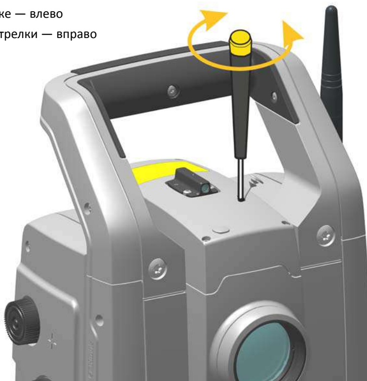
Рисунок 4.7. Юстировка положения лазерного указателя по горизонтали
